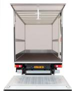
Vollständig lichtdurchlässiges Dach. Leicht gewölbt zur Gewährleistung der Entwässerung. Serienmäßig ausgestattet mit einer LED-Deckenleuchte mit PIR-Bewegungsmelder.
