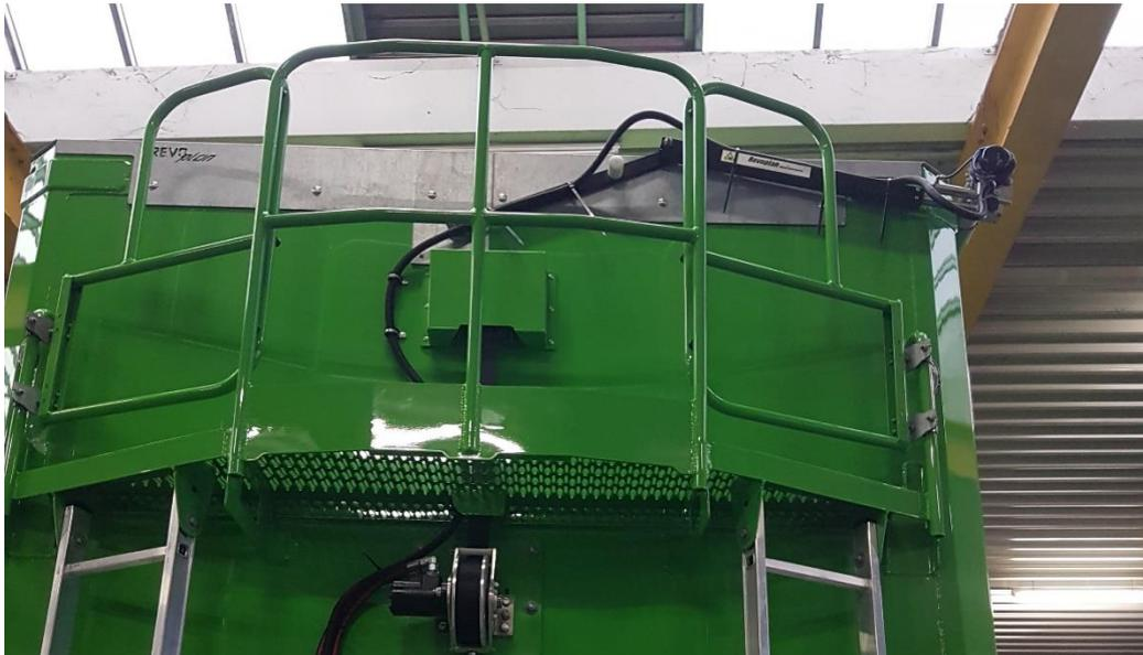
REVOplan für Schubboden, im geschlossenen Zustand liegt die Wickelwelle außerhalb des Gurtprofils
