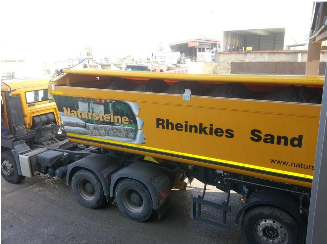
Das Verdeck ist bis zu einer Muldenlänge von 7300 mm freitragend, darüber mit Zwischenstütze (Verdeckbogen mittig)
