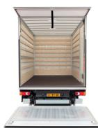
Aluminium Unterbau mit Quer- und Längsträgern und phenolharzverleimte skandinavischen Fahrzeugbodenplatte mit einer Stärke von 15 mm; einteilig mit rutschhemmender Siedruck-Oberfläche. Schnittkanten, Ränder und Bohrungen versiegelt.
