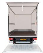
Vollständig isoliertes Dach mit einer Stärke von 25 mm und Querrohre zur Verstärkung. Serienmäßig ausgestattet mit einer LED-Deckenleuchte mit PIR-Bewegungsmelder.
